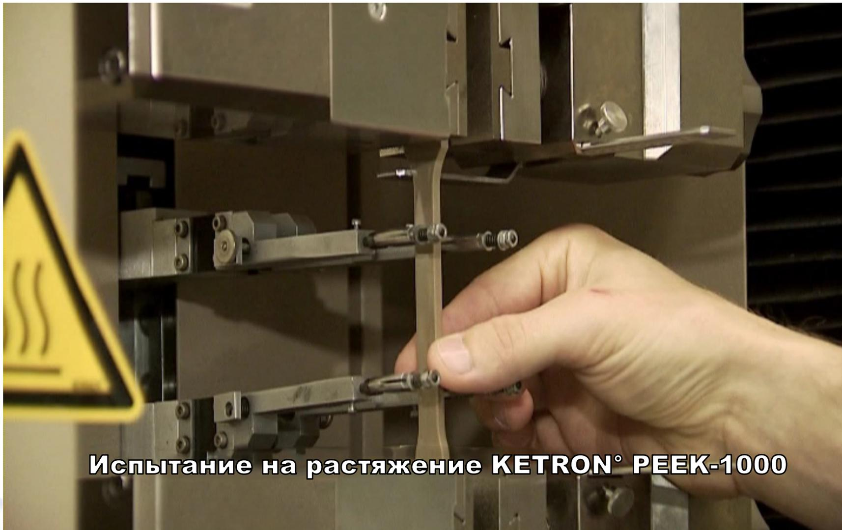
Испытание на растяжение КЕТРОН® РЕЕК-1000
